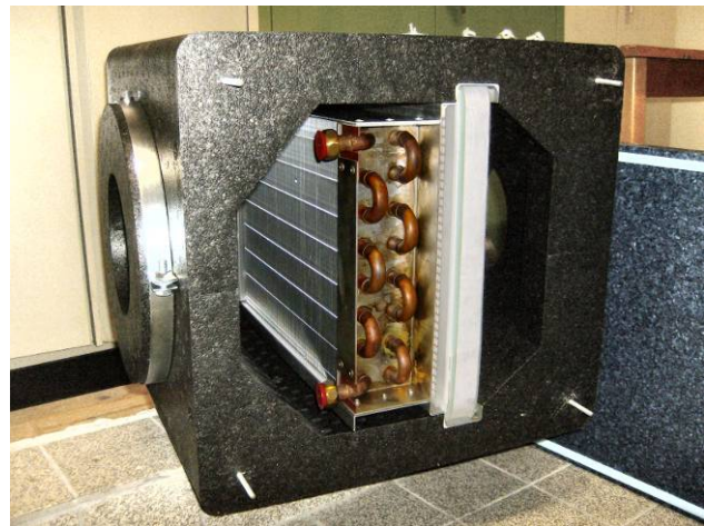
Bild 2 Filterbox mit Ansicht auf Wärmetauscher und Filter
